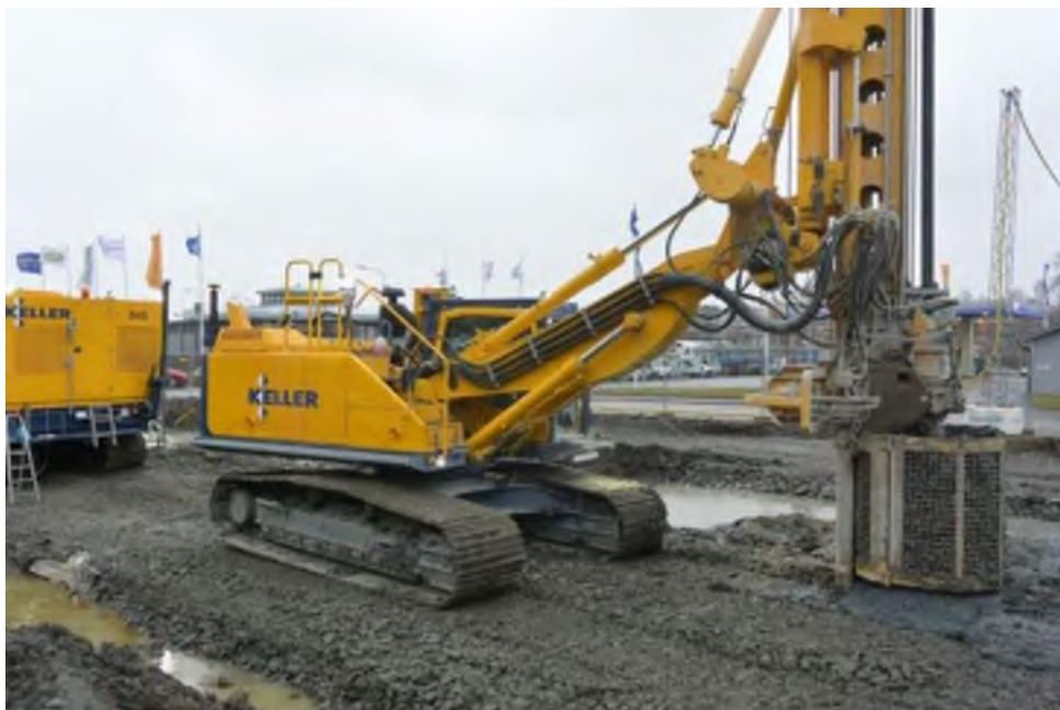
Figur 1 Två typiska maskiner som installerar kalkcementpelare i de Nordiska länderna. Ovan en maskin från Dmixab och därunder en maskin från Keller.
